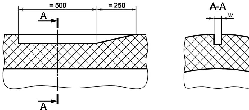
$w$  — ширина канавки (от 8 до 25 мм в зависимости от толщины стенки); острые углы на дне канавки — скруглить
