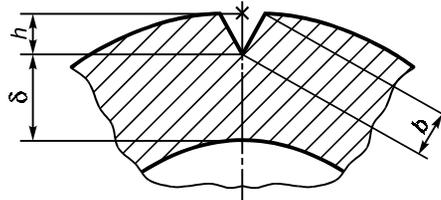
$b$  — ширина обработанной фрезерованием поверхности надреза;  $h$  — глубина надреза;
